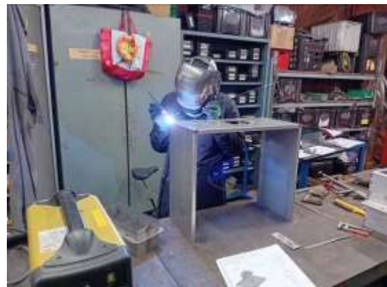
Montage et soudure inox
