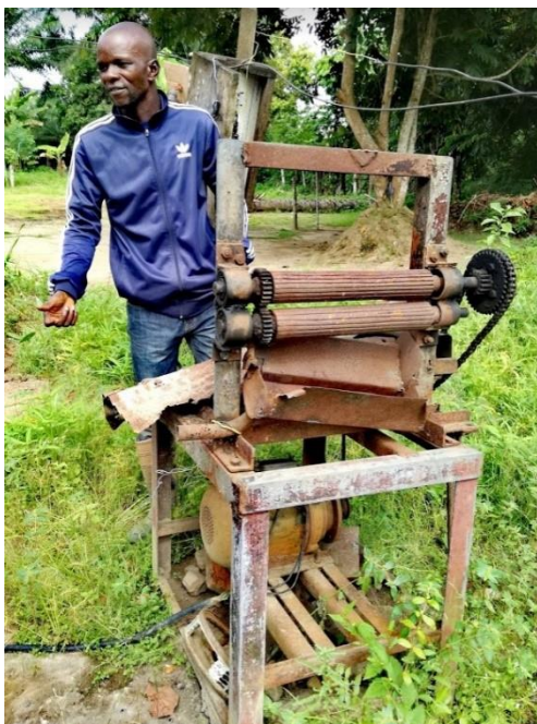
Fabrication locale d'une presse à cannes à sucre. Très rudimentaire, elle n'apporte pas l'efficacité souhaitée.
