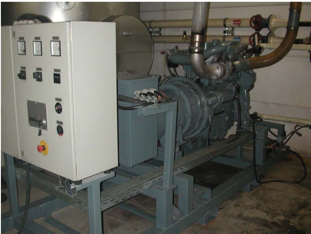
(Figure (A.15), laboratoire AAN ; Nommé 4 P 13,5 ; Moteur sur banc d'essai AAN muni de tout l'équipement de freinage de couple, mesures de puissance et de pollution,... ; 4 cylindres, 5.9 dm 3 , 80 à 105 kW)
