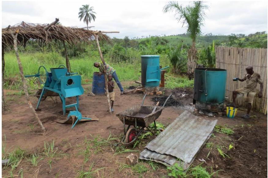
Le cuiseur permet de cuire 240 kg de fruits de palme. Le fond est en pente et permet l'écoulement facile des noix de palme. Un foyer incorporé permet de chauffer les noix au bois
